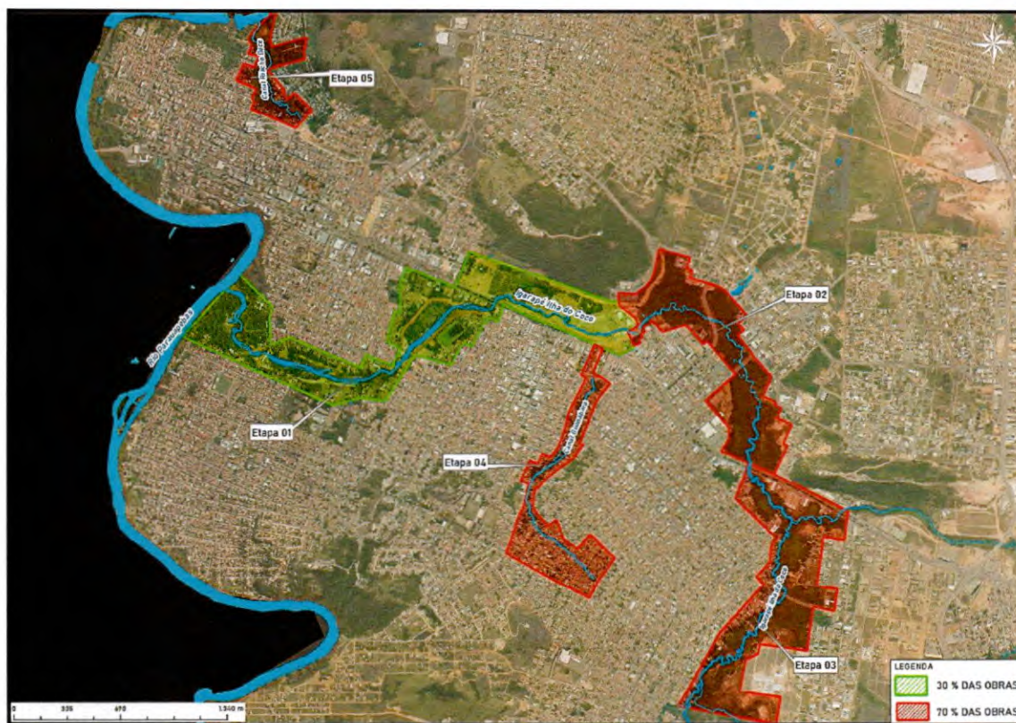
Figura 1: Etapas de obras do projeto com financiamento BID. A Etapa 2 se refere a segunda etapa de obras do igarapé Ilha do Coco, cuja execução é objeto deste Projeto Básico
